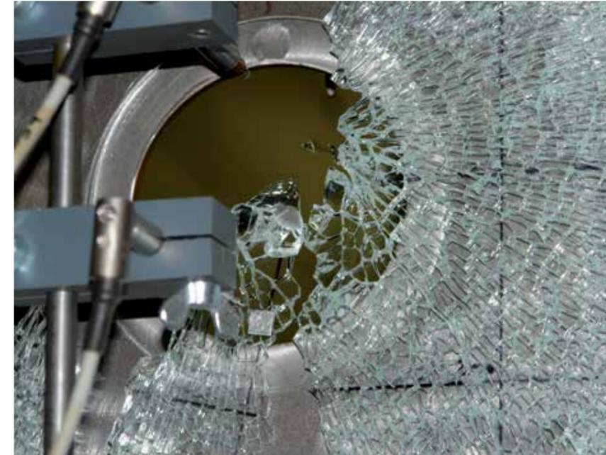
*Projet sur la construction filigrane en acier et verre. Point de fixation après fissure*
