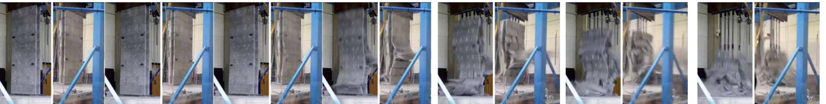
Test sur un mur réalisé en blocs modulaires jusqu'à la destruction
