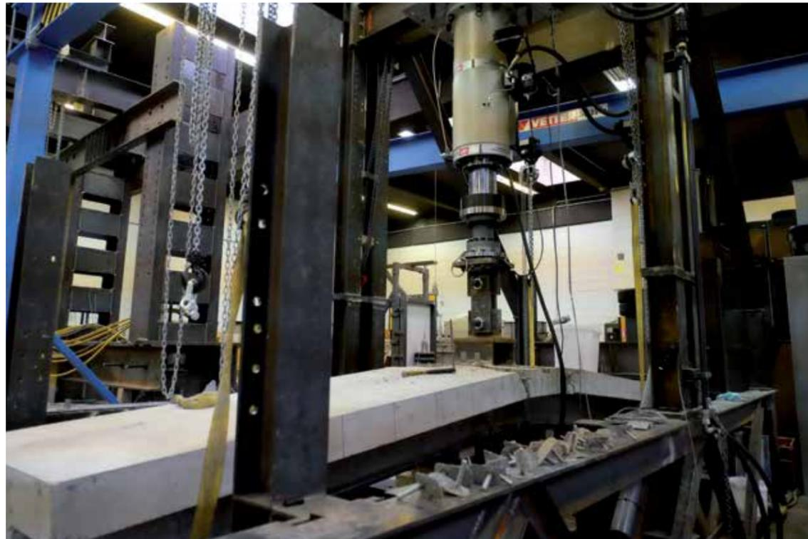
*Presse hydraulique avec dalle CoSFB fissurée*
