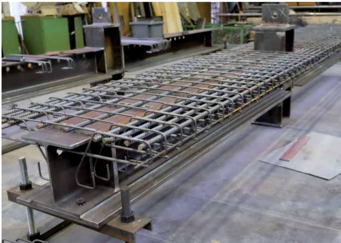
Projet CoSFB (Composite Slim Floor Beam) portant sur une dalle à faible épaisseur. Poutre avec profil nouveau développé par ArcelorMittal
